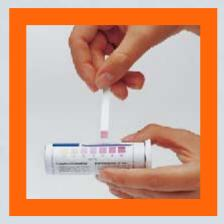
3. Nach der vorgegebenen Reaktionszeit, die maximal 2 Minuten dauert, vergleicht man die Färbung der Reaktionszone mit der Farbskala auf der Packung, um die Konzentration zu ermitteln.
