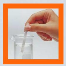
2. Die Reaktionszonen werden durch kurzes Eintauchen mit der zu prüfenden Lösung benetzt. Die überschüssige Flüssigkeit wird danach abgeschüttelt.
