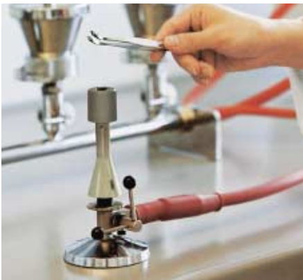
Pinzette abflammen, kurz auskühlen lassen
