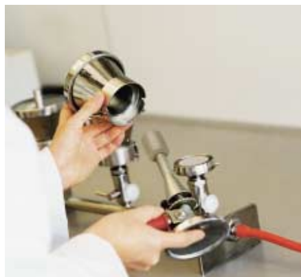
Abflammen des Trichters von unten
