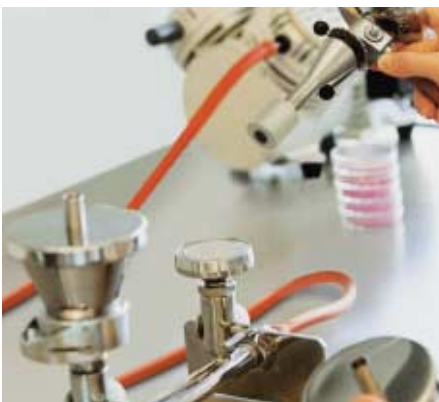
Vakuuhahn öffnen. Filtertisch abflammen und Vakuuhahn wieder schließen.
