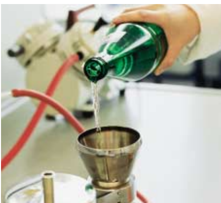
Probe filtrieren und mit steriler, physiologischer Kochsalzlösung nachspülen
