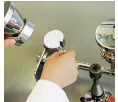
Filter auf den Filtertisch auflegen; eventuell vorhandenes gelbes Deckblatt (nicht abgebildet) verwerfen, bevor Trichter oder Oberteil des Filtrationsgerätes montiert werden.
