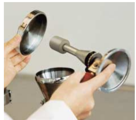
Vakuuhahn öffnen und Trichter von innen abflammen. Vakuuhahn wieder schließen und Deckel abflammen.
