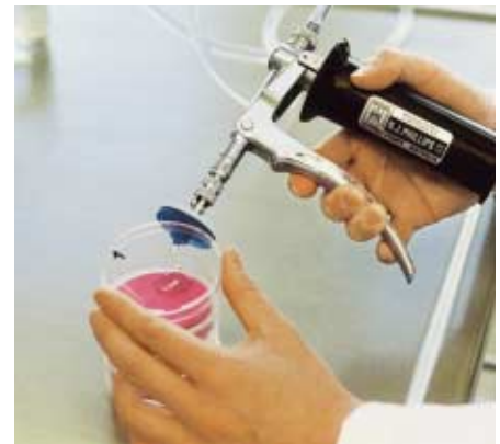
Nährkartonscheiben mit 3,5 ml sterilem destilliertem oder demineralisiertem Wasser benetzen
