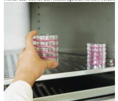
Petrischale mit Deckel nach oben (nicht umgekehrt!) bebrüten
