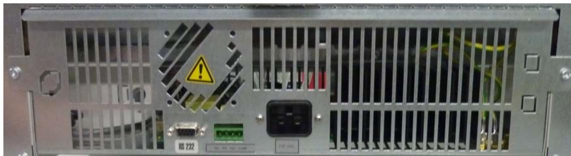
**Abbildung 5-6 Netzanschlussbuchse**
