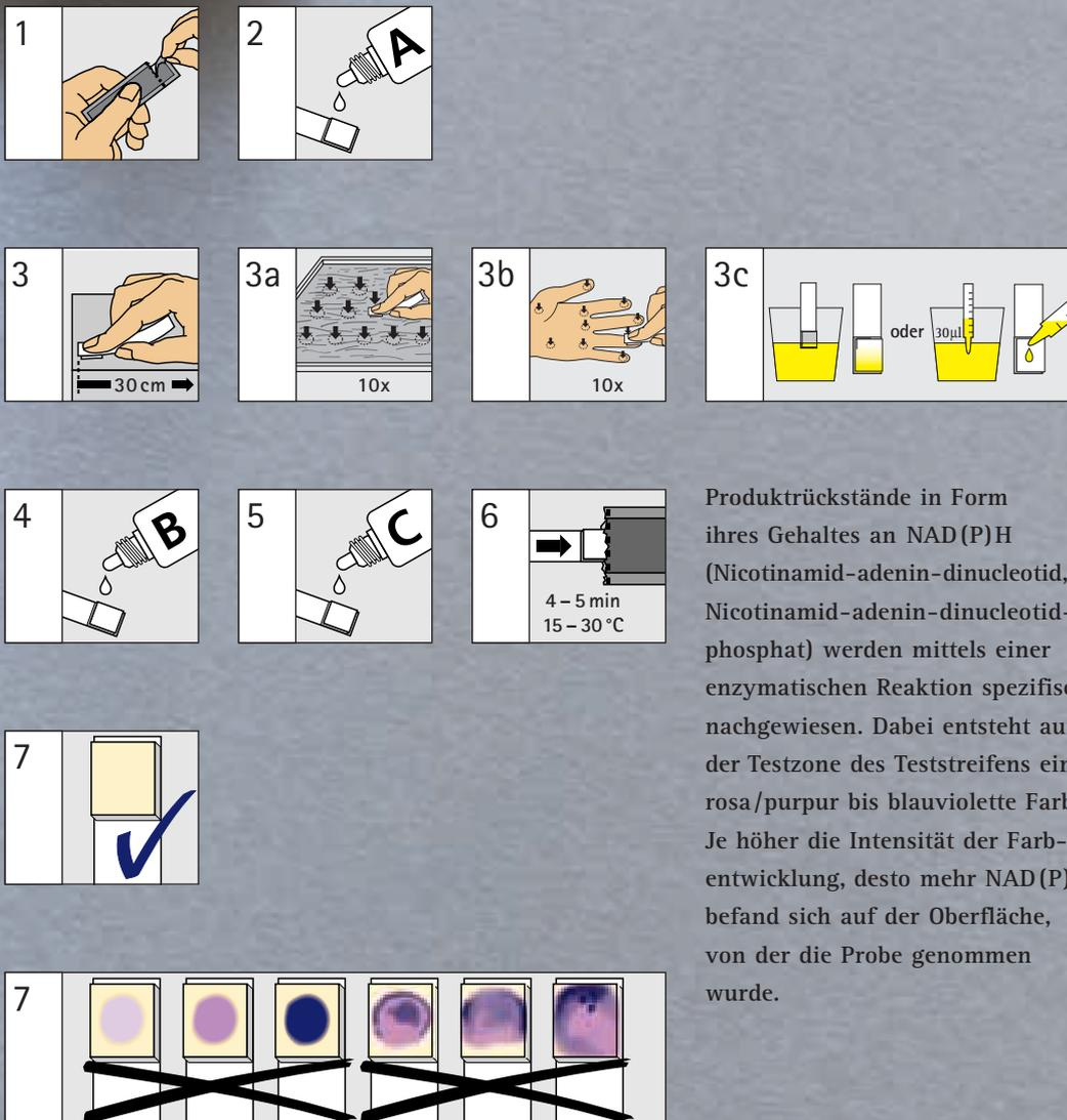
Produktreste in Form ihres Gehaltes an NAD(P)H (Nicotinamid-adenin-dinucleotid, Nicotinamid-adenin-dinucleotid-phosphat) werden mittels einer enzymatischen Reaktion spezifisch nachgewiesen. Dabei entsteht auf der Testzone des Teststreifens eine rosa/purpur bis blaviolette Farbe. Je höher die Intensität der Farbentwicklung, desto mehr NAD(P)H befand sich auf der Oberfläche, von der die Probe genommen wurde.
